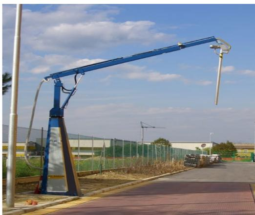
Figura 1. Sonda preleva campioni automatica
