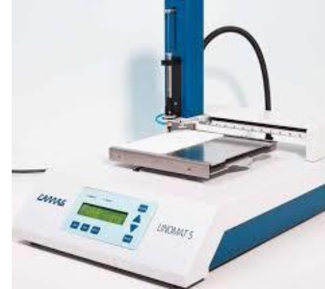
FASE 3: deposizione campioni su lastre in silice HPTLC
