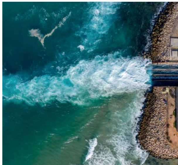
Figura 1 - Condotta di scarico a mare di salamoia in un impianto di dissalazione
