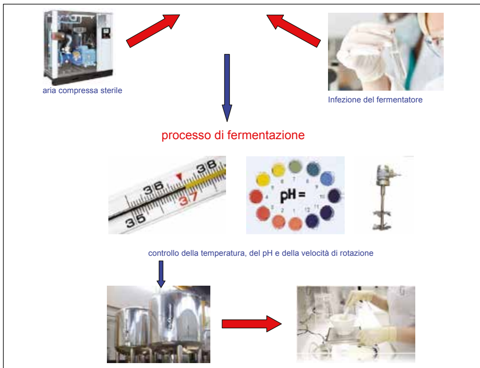
Schema di un ciclo (batch) di fermentazione (submerged fermentation, SmF)
