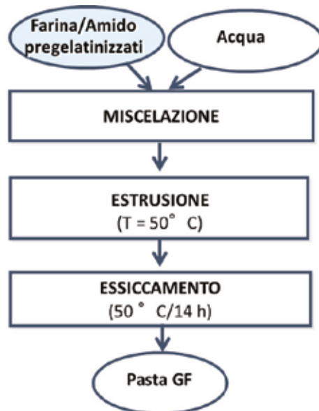
Figura 14 - Processo di produzione di pasta gluten-free con materie prime termotrattate.
