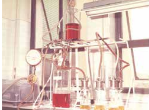
Filtrazione di terreno colturale attraverso filtri sterilizzanti Seitz EKS 1
