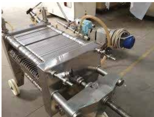
Filtrazione del terreno direttamente nel fermentatore attraverso filtri sterilizzanti Seitz EKS 1
