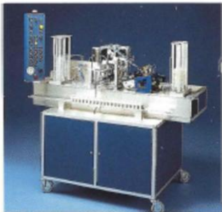
Il Petri-Foss è un sistema interamente automatico destinato alla preparazione delle piastre per la qualità igienica del latte crudo.
