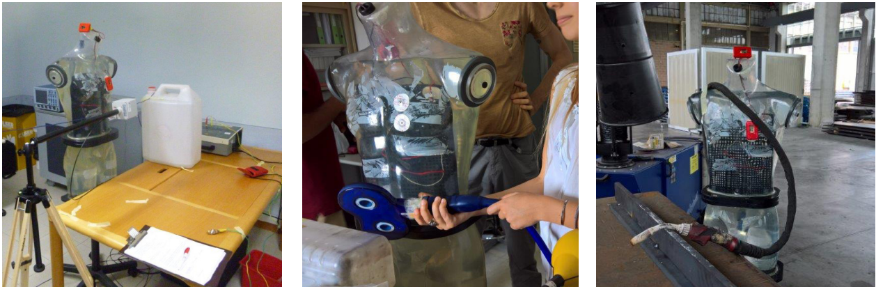
Figura 2 - Manichino antropomorfo utilizzato per le misure sperimentali in vitro per la valutazione del rischio di lavoratori con PM esposto a campi elettromagnetici generati da elettrobisturi, stimolatori transcranici e saldatrici industriali
