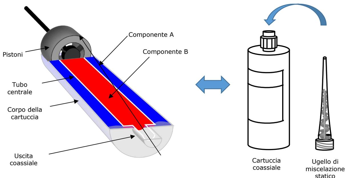
Nel caso di una cartuccia coassiale, è presente un imballaggio esterno, un unico contenitore visibile all'utilizzatore. Per garantire l'uso sicuro del prodotto bicomponente racchiuso nella cartuccia, è necessario che quest'ultima sia etichettata con una vera e propria etichetta a norma del CLP in cui i relativi elementi per ogni miscela dei componenti siano chiaramente separati per distinguerli tra loro.
