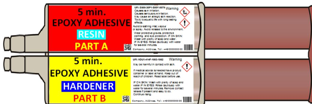
In questo tipo di situazione si devono apporre due etichette distinte sui contenitori, ossia un'etichetta per ciascuna miscela (in un contenitore). Le indicazioni di pericolo fornite sulle etichette devono riguardare gli stati fisici/la forma in cui entrambe le miscele (parte A e parte B) sono immesse sul mercato. Non è necessario che l'imballaggio esterno dell'intero kit sia etichettato, poiché è trasparente e permette di vedere chiaramente l'imballaggio interno (di entrambi i contenitori).
