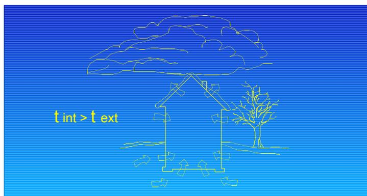
Figura A1.3. Meccanismi di ingresso: effetto camino
