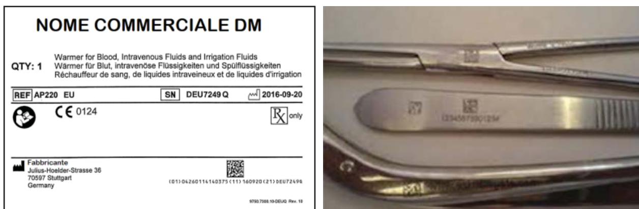
Figura 4 - A sinistra: esempio di apposizione del vettore UDI sull'etichetta; a destra: apposizione del vettore UDI sul dispositivo medico
