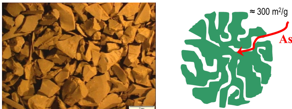
Figura 5. Idrossido ferrico granulare (a sinistra) e rappresentazione della superficie specifica del granulo (a destra). Fonte: SII ScpA – Riprodotta con autorizzazione
