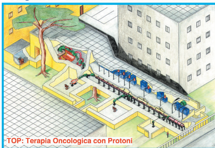
Figura 7. Rappresentazione artistica del progetto di acceleratore per protoni per terapia oncologica oggetto di una collaborazione fra Istituto Superiore di Sanità, ENEA ed Istituto Regina Elena di Roma
