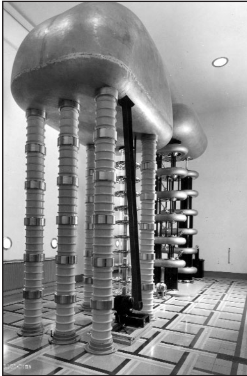
Figura 4. L'acceleratore di Cockroft-Walton per neutroni realizzato presso l'Istituto Superiore di Sanità
