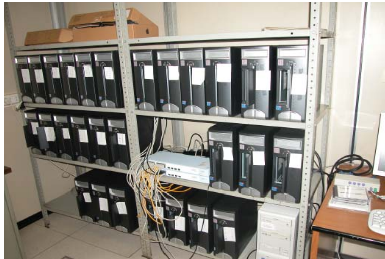
Figura 2 - Cluster di 29 nodi di calcolo allestito presso l'Istituto Superiore di Sanità
