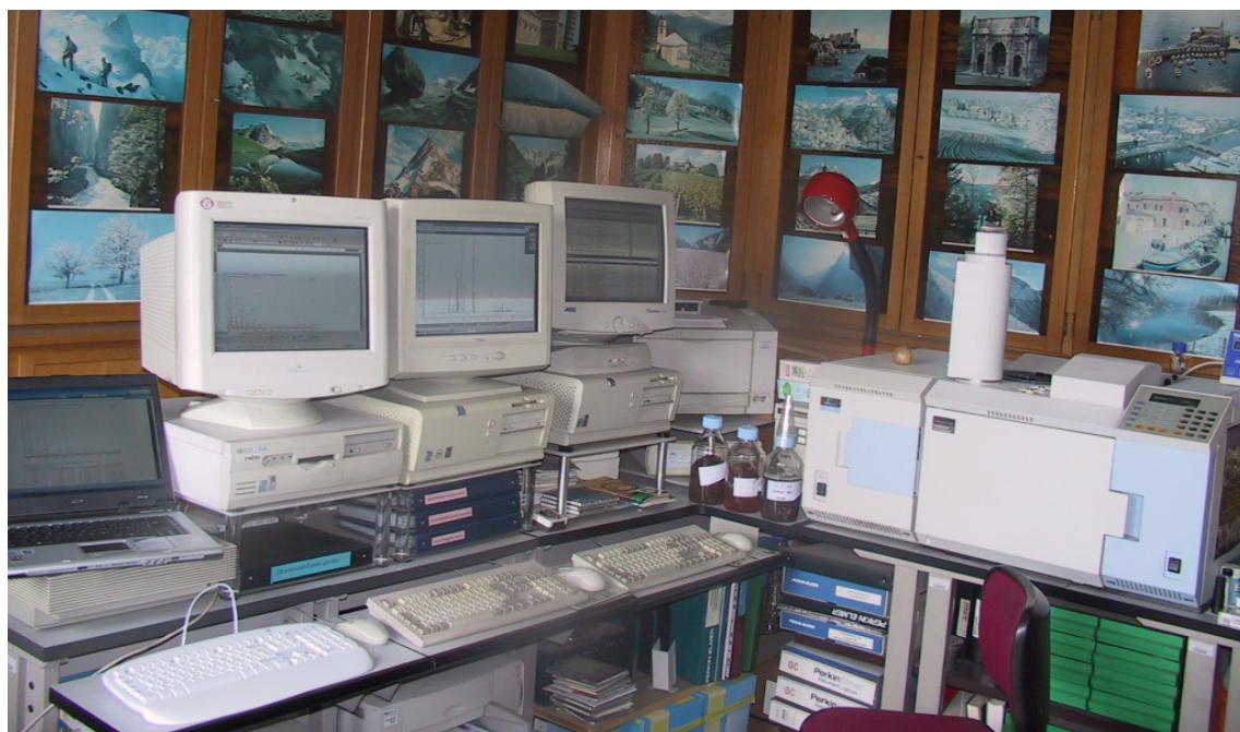
Figura 9. Postazione GC-FID (TurboChrom) e GC-MS (TurboMass Analytical Workstation e NIST/EPA/MSDC Mass Spectral Database), quest'ultima utilizzata per l'analisi SPME-HS/GC-MS. La postazione è collegata con un altro GC-FID posto in una stanza attigua
