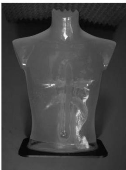
**Figura 47. Simulatore di tronco antropomorfo per le misure di temperatura e SAR in MRI clinica**
