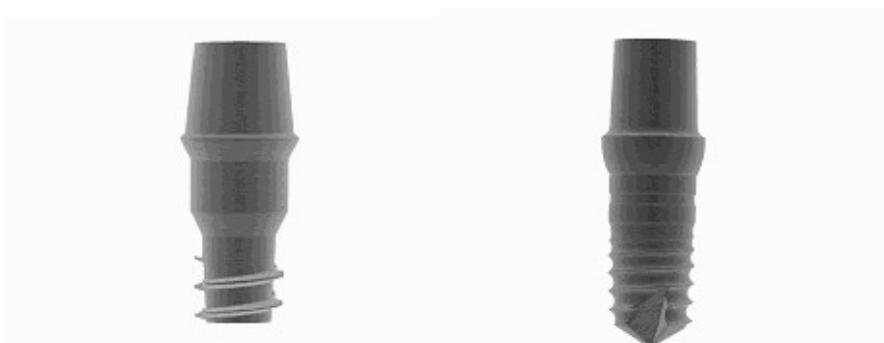
**Figura 5. Immagine 3D dell'impianto A (sinistra) e B (destra) ottenute per mezzo del sistema microCT Skyscan 1072**
