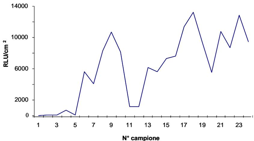
Figura 11. Andamento dei valori di ATP determinati nel biofilm sviluppato sulla superficie dei tubi di PE-Xb
