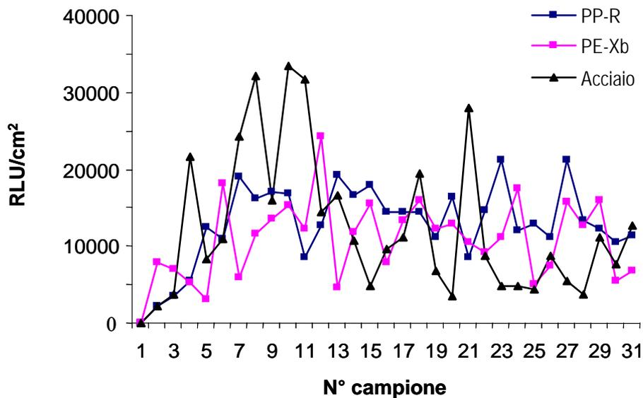
Figura 2. Andamento delle concentrazioni di ATP nel biofilm sviluppato sulle superfici dei tubi di PP-R, PE-Xb e acciaio
