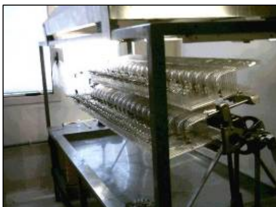
Figura 1. Craig-post apparatus. Sistema di separazione liquido-liquido composto da 200 tubi collegati tra loro e contenenti ciascuno 10 mL di fase inferiore (fase stazionaria) e 10 mL di fase superiore (fase mobile)
