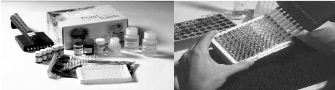
Figura 5. Contenuto di un kit EIA e fase dell'esecuzione di un saggio immunoenzimatic in formato micropiastra
