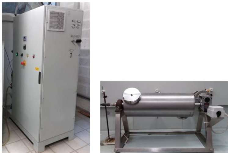
Figura 1. Generatore di ozono in grado di produrre 55 g O 3 /h e camera di miscelazione/contatto motorizzata
