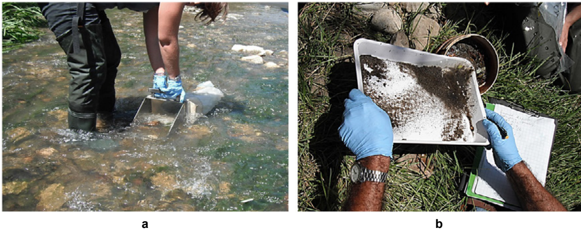
Figura 3. Campionamento del macrobenthos: a) raccolta del materiale tramite Rete Surber ; b) setacciatura e smistamento del materiale raccolto
