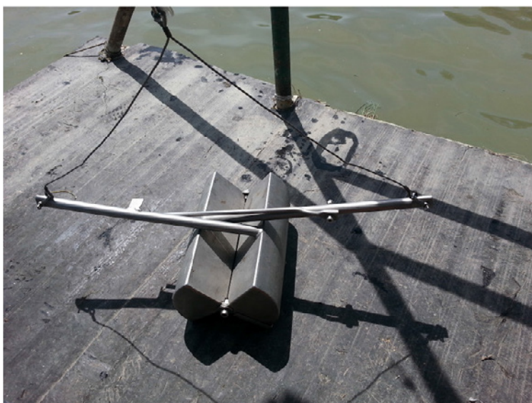
Figura 2. Strumento meccanico (Benna Van Veen) per il campionamento dei sedimenti superficiali
