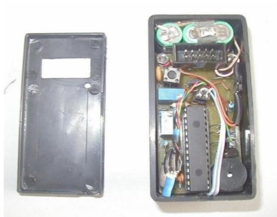
**Figura 4. Il contapassi basato sull'espansione del gastrocnemio (GEMU): Componentistica**
