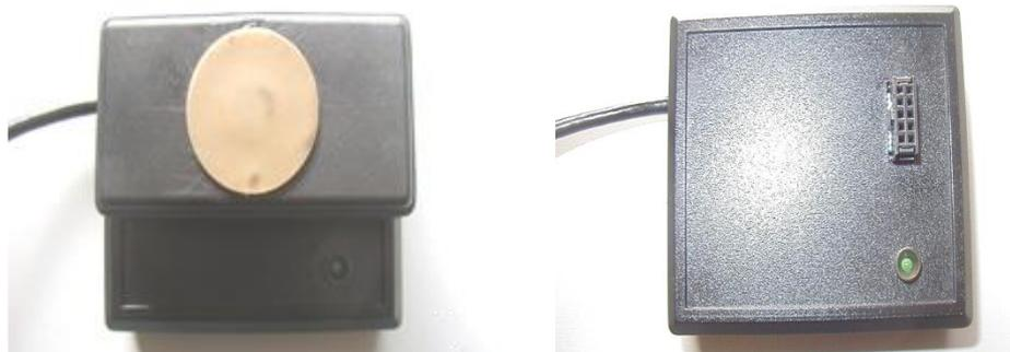
**Figura 6. Contapassi basato sull'espansione del gastrocnemio (GEMU): sensore e unità per la ricarica**
