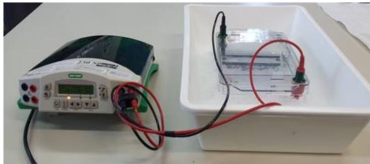
Figura 2. Vaschetta elettroforetica immersa in ghiaccio per mantenere freddo il tampone durante la corsa
