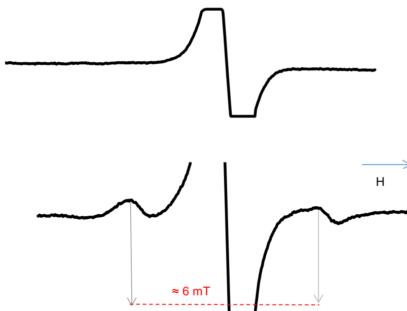
Figura 11. Esempi di spettri ESR di nocciole non irradiate (a) e irradiate alla dose di circa 6 kGy (b) (le frecce indicano i picchi satelliti distanti circa 6 mT)
