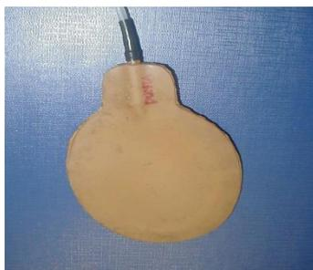
Figura 2. Attuatore per la restituzione sensoriale (vescica)
