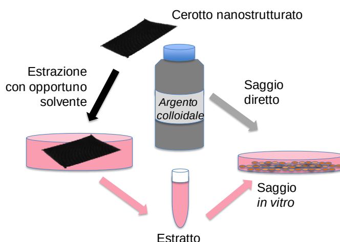
Figura 4. Test di citotossicità: saggio diretto e in seguito a estrazione
