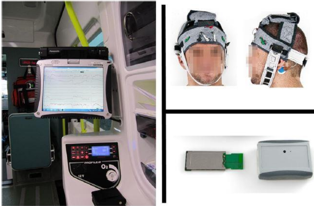
Figura 12. Sistema EEG composto da: tablet con software per monitoraggio e registrazione dei dati (a sinistra), caschetto con sensori (in alto a destra), dispositivo per l'acquisizione dei dati EEG (in basso a destra)
