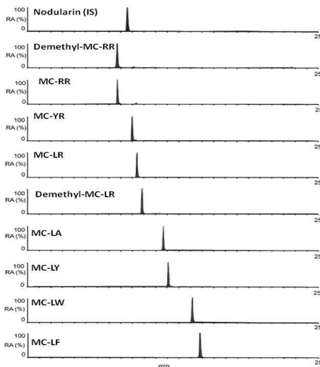
**Figura 1. Cromatogramma rappresentativo risultante da un'iniezione di 0,5 L di un campione bianco contaminato con 0,1 µg/L di una miscela delle microcistine selezionate e 1 µg/L dello standard di processo, determinato tramite LC-MSMS in modalità MRM**
