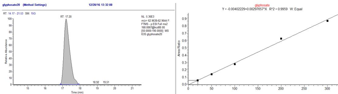
**GLIFOSATO: prove di verifica dell'esattezza mediante aggiunte note su matrice reale utilizzando per la quantificazione, lo standard interno marcato <sup>13</sup>C<sub>2</sub>, <sup>15</sup>N-glifosato**
