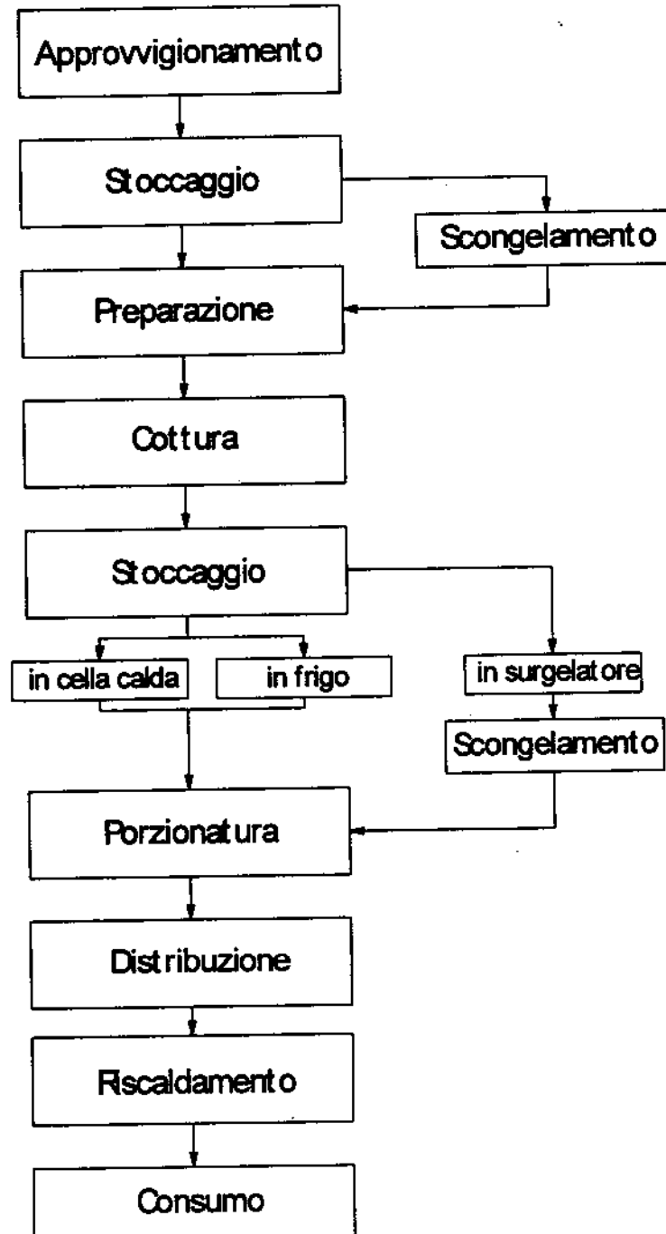
Fig. 1 - Diagramma di flusso riferito ad un ipotetico ciclo di lavorazione di un esercizio di ristorazione collettiva
