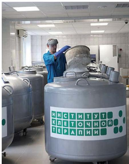
**Figura 3.** Bidone contenente azoto liquido alla temperatura di circa  $-150^{\circ}\text{C}$  per il congelamento di cellule.
