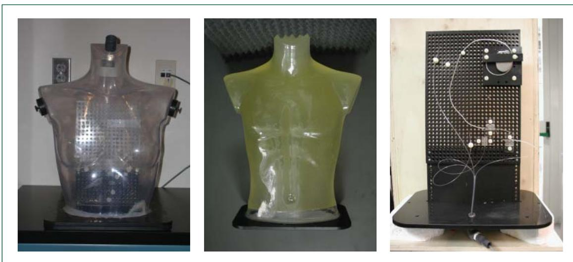
**Figura 3** - Simulatori di tronco antropomorfi all'interno dei quali riprodurre le tipiche condizioni di impianto per un PM, realizzati dal Reparto di Bioingegneria Cardiovascolare dell'ISS
