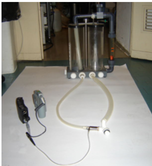
Figura 1 - La pompa Jarvick 2000 nei test di laboratorio. Apparato sperimentale adottato per la caratterizzazione in vitro della pompa Jarvick 2000 co-assiale. In basso, a sinistra, sono mostrati il controller (nero) per la selezione del regime di rotazione e la batteria (grigio)
