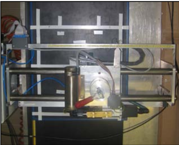
Esempio di dispositivo di test per la valutazione delle prestazioni di misura di PPMD (visto dall'alto). Rappresenta un dispositivo di test pneumatico senza membrana interposta, brevemente descritto nell'allegato B della Norma CEI 62-236, unitamente ad altri possibili dispositivi di test
