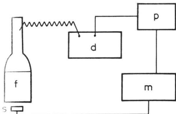
Fig. 28b. - Dispositivo per la regolazione del guadagno (d). s = sorgente luminosa emettente 1000 flash al secondo; p = circuito di paragone; m = microprocessore; f = fototubo.
