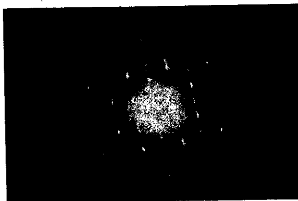
FIG. 4. - Figura di diffrazione elettronica di una fibra di crisotilo.
