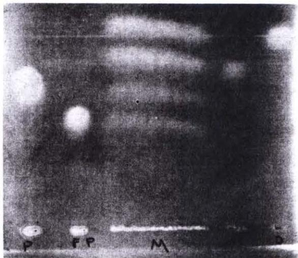
Fig. 3. — Separazione cromatografica su strato sottile di allumina GF<sub>254</sub> del testosterone propionato (P), fenilpropionato (FP), 4-metilpentanoato (IC), decanoato (D), (solvente: etere di petrolio-acetato di etile 90:10).
