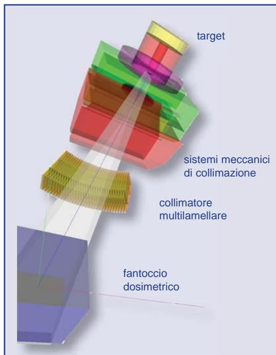
Tali sistemi di collimazione vengono regolati sulla base di calcoli effettuati tramite algoritmi matematici e/o modelli di simulazione numerica (tecniche di simulazione Monte Carlo), con i quali si riesce a valutare tutti i parametri necessari per avere il massimo del beneficio sul paziente e il minimo del rischio.
