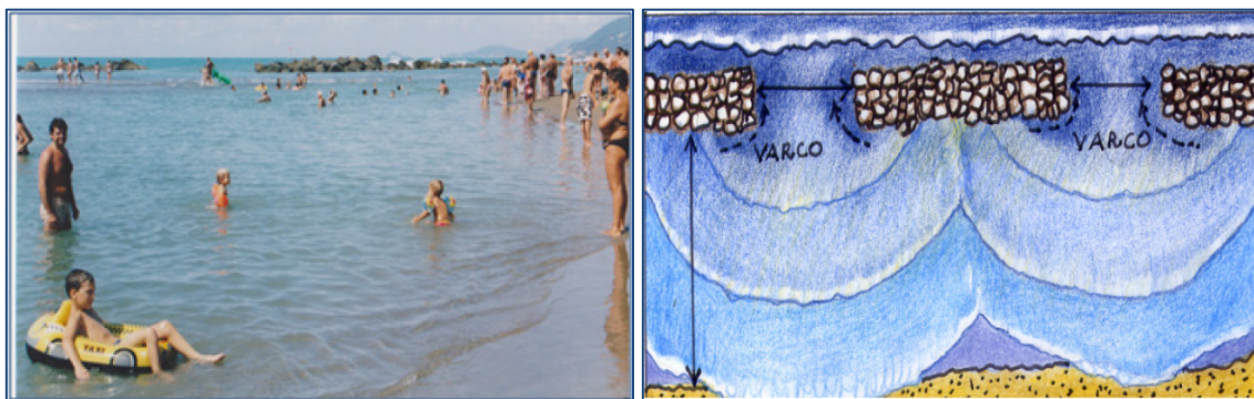
Figura 21. Barriere parallele e correnti di uscita
