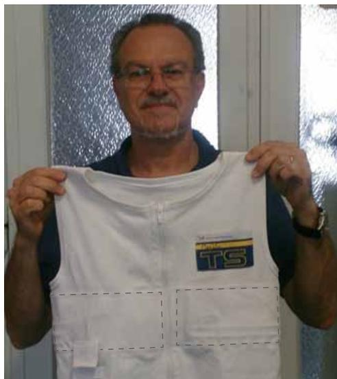
**Figura 5** - La maglietta sensorizzata (Fondazione Don Gnocchi di Milano) dotata di fascia per la misura di ECG, respirazione e accelerazioni corporee
