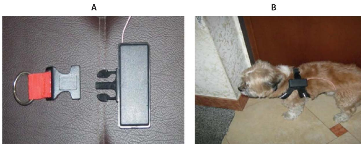
Figura 4 - Dispositivo contapassi canino: a) dettaglio relativo ad ancoraggio; b) posizionamento sul cane
