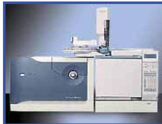
Gas cromatografo-spettrometro di massa
