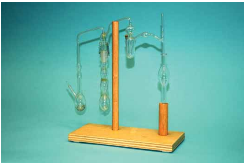
Apparecchio per la microdeterminazione dei gruppi metossilici.
