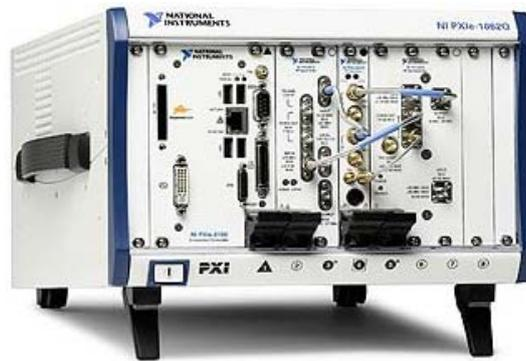
Figura 1. Sistema PXI per la generazione dei protocolli di comunicazione RFId
