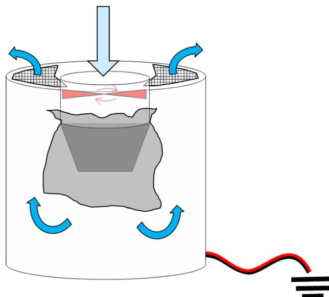
**Figura 84. Schema di una trappola BG sentinel. Dall'alto in basso le parti principali: cilindro di ingresso, retine per il deflusso dell'aria e dell'attrattivo chimico, elica per generare il flusso di aspirazione, retina di raccolta degli esemplari catturati**
