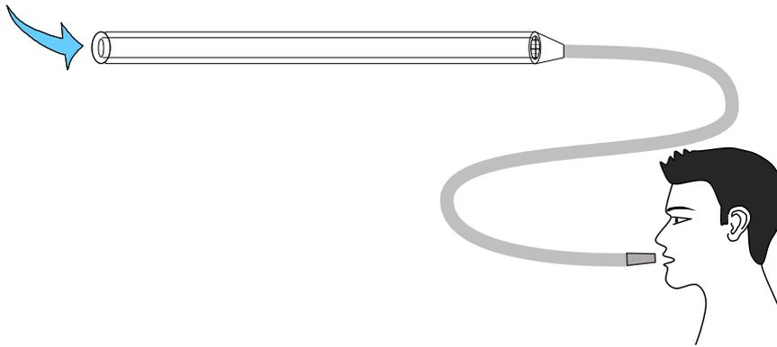
**Figura 82. Schema generico di aspiratore a bocca. Alla base del tubo rigido è presente una retina per impedire l'ingestione accidentale delle zanzare da parte dell'operatore. In grigio è rappresentato il tubo flessibile con il bocaglio per facilitare l'aspirazione**
