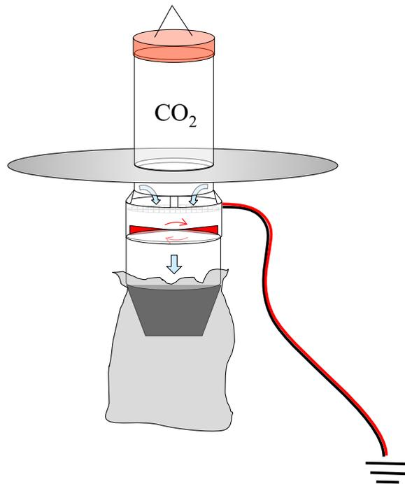
**Figura 83. Schema di una trappola CDC. Dall'alto in basso le parti principali: contenitore per il ghiaccio secco (CO<sub>2</sub>), disco rigido per convogliare il cono di luce verso il basso, elica per generare il flusso di aspirazione, retina di raccolta degli esemplari catturati**
