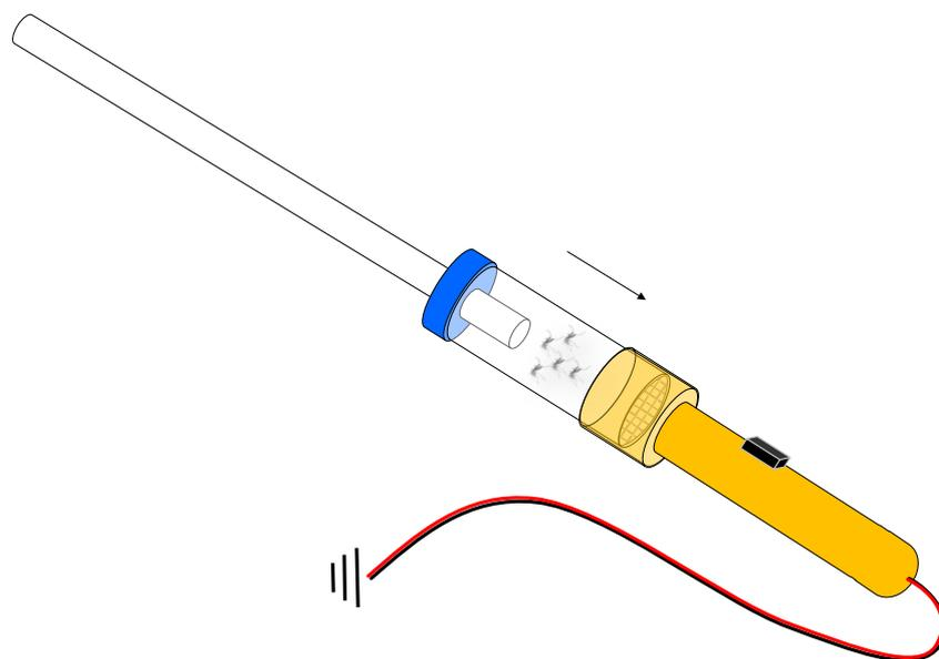
**Figura 81. Schema generico di aspiratore elettrico ottenuto modificando un aspiratore disponibile in commercio e inserendovi una provetta da 50 mL adattata con una retina alla base e un foro nel tappo per inserire la canna nella parte apicale**
