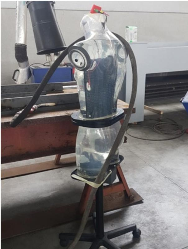
Esempio di set-up sperimentale per la valutazione dei rischi di interferenza elettromagnetica su un pacemaker derivanti dall'utilizzo di una saldatrice elettrica industriale. Il pacemaker è inserito all'interno di un manichino antropomorfo riempito con una soluzione salina che riproduce le caratteristiche elettriche medie del corpo umano
