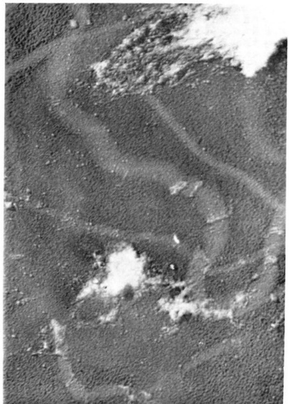
Fig. 11. - Microfibrille reticolari dopo prolungato lavaggio in soluzione acida (pH = 3,8) ( \times 10000 ).
