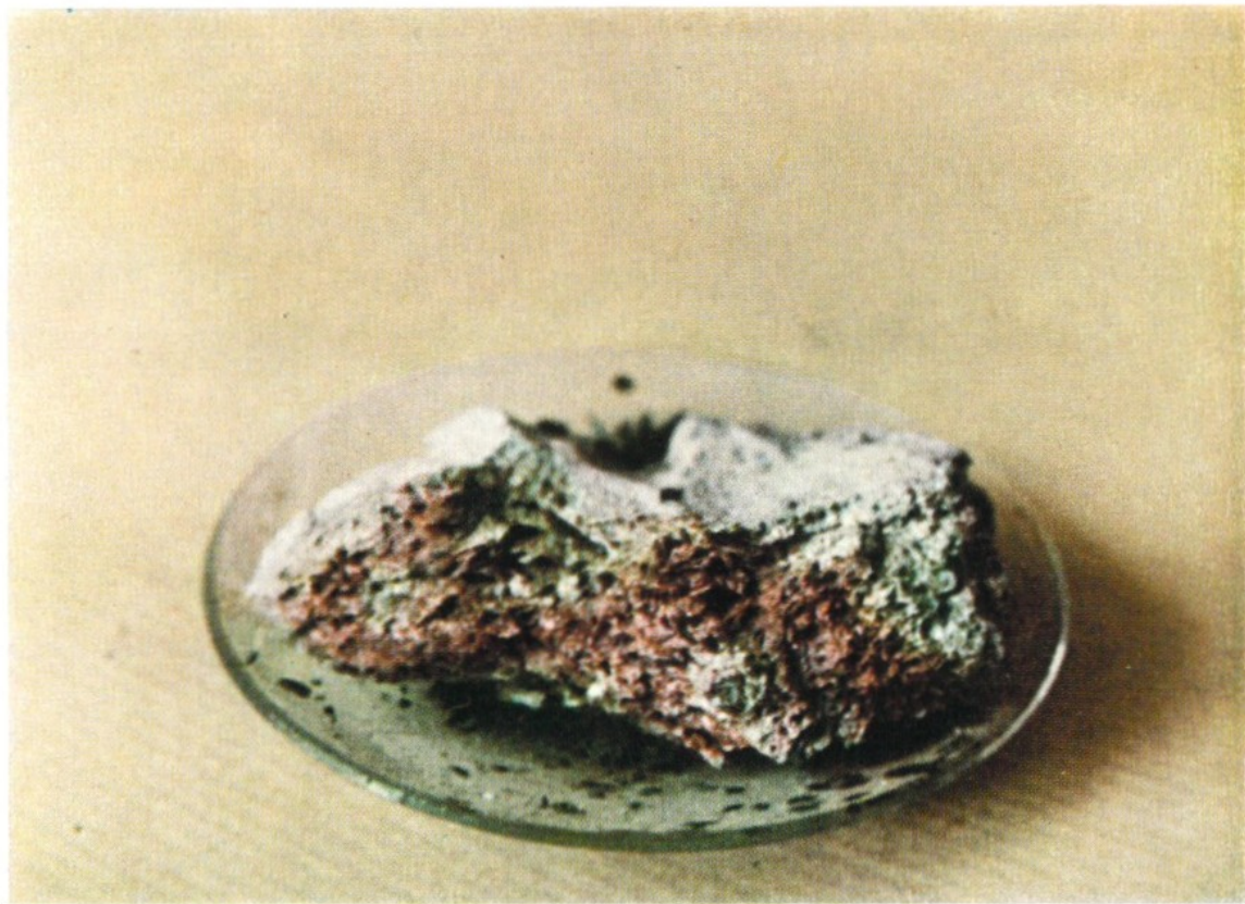
Fig. 4. - Zolla di argilla a contatto con la tubazione grafitizzata da corrente dispersa.
