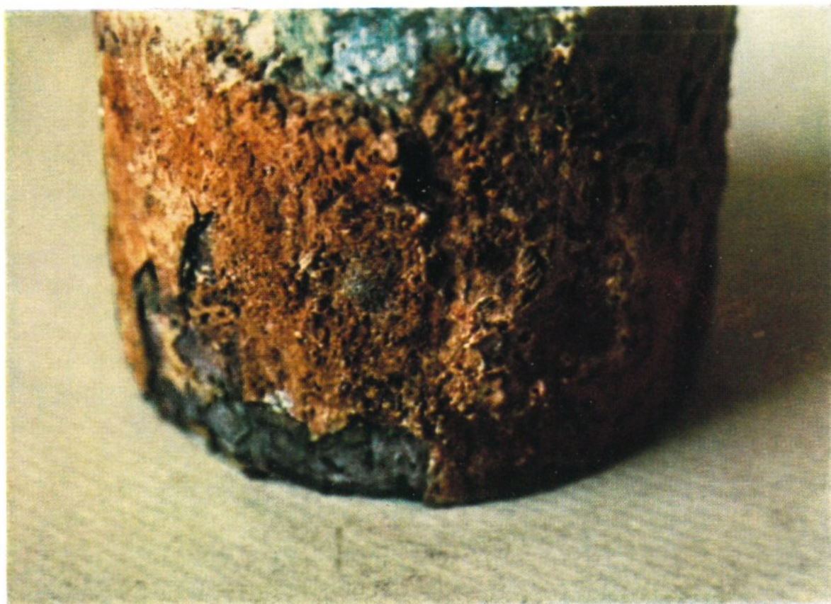
Fig. 6. - Effetto distruttivo sulla pellicola catramata di rivestimento di una tubazione di ghisa dovuto ad eccesso di protezione catodica.
