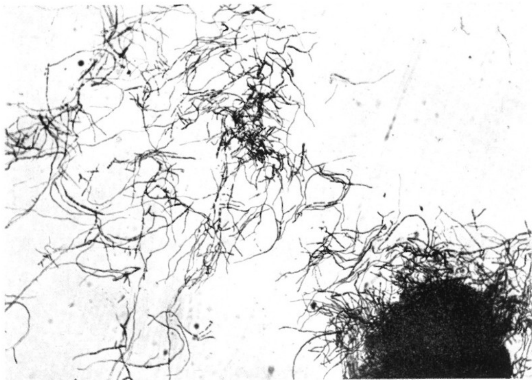
Fig. 8. - Micelio lungo, filamentoso e palletta dopo 47 ore di sviluppo in fermentatore da 12.000 litri. (Sistema con antivortici, 160 g. p. m., 600 mm \phi ) \times 150.
