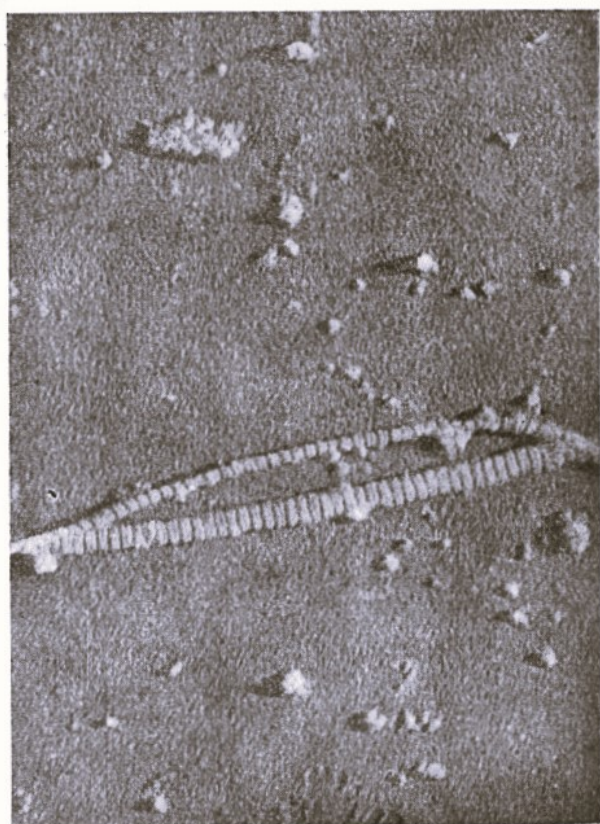
FIG. 4 - Fibrille collagene non liofilizzate. Dilacerazione in acqua a 40°. 18.000 x
