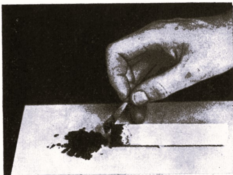
FIG. 3 - Estrusione della colonna cromatografica e separazione delle zone.
