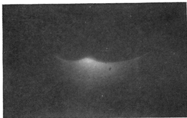
Fig. 5. - Sorgente di Po, protetta da un foglio di Al, in soluzione di terfenile in xilolo 5 0 / 00 .
